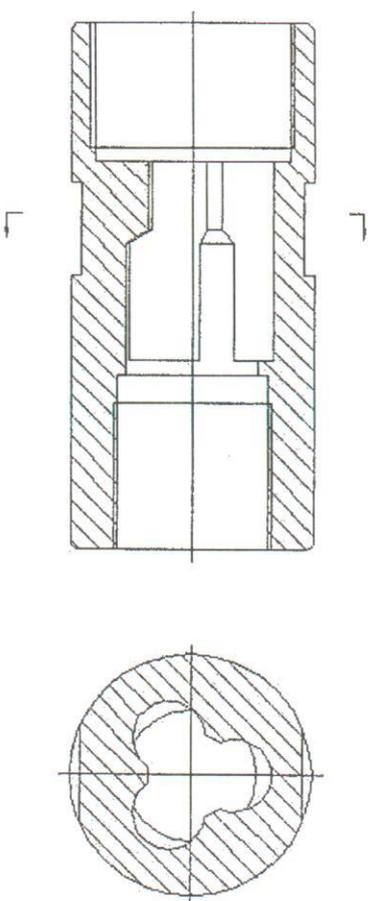
**Корпус всасывающего клапана
